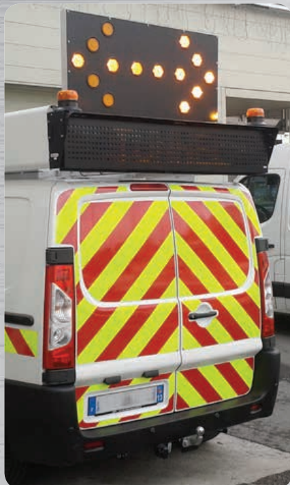
Panneaux à messages variables (PMV) sur pavillon ou en applique sur face arrière
